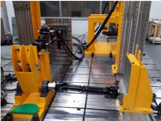
Şekil 9. Yorulma testi için oluşturulan test tezgâhı
