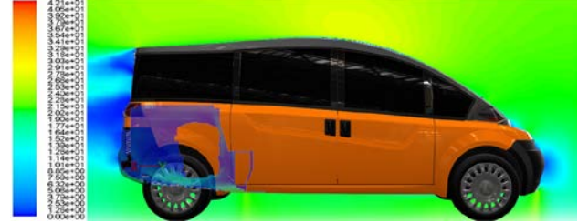
Şekil 6. Hız konturları (km/h) (Araç tabanı ile yönlendirme plakası aynı düzlemde) (Araç hızı: 25km/h)
