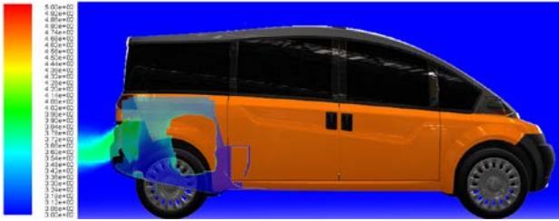
Şekil 5. Motor kompartmanı sıcaklık konturları (K) (Motor + radyatör bölümü - ayırma plakası olmadığı koşul)
