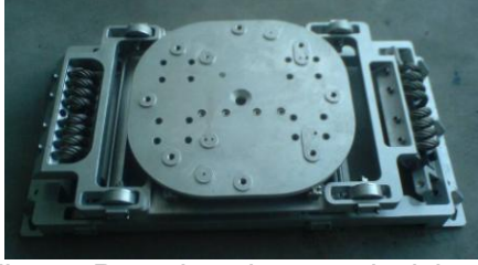
Şekil 13 – Prototip şok sönümleyici tabla Şekil 14 – Test düzeneği
