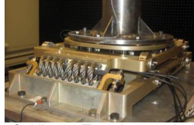
Şekil 13 – Prototip şok sönümleyici tabla Şekil 14 – Test düzeneği
