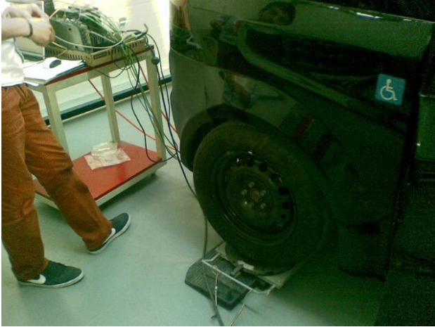
Şekil 14. Teker açısı ölçüm tablaları üzerinde sistem performansının ayarlanması
