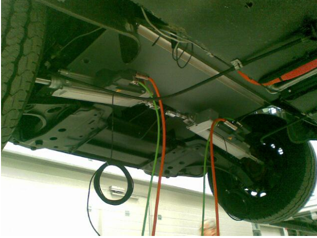
Şekil 13. Araca monte edilen doğrusal eyleyiciler
