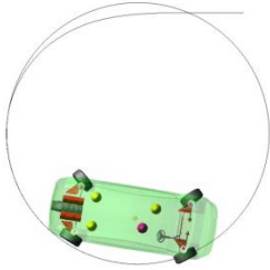
Şekil 10. Dört tekerlekten yönlendirilebilir aracın tam-taşıtlı modeli
