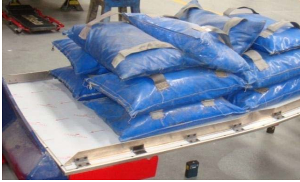
Şekil 11: Deforme Olmuş Test Numunesi
