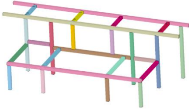
Şekil 5. Koltuk baėlantısını saėlayan uzay kafes yapısı
