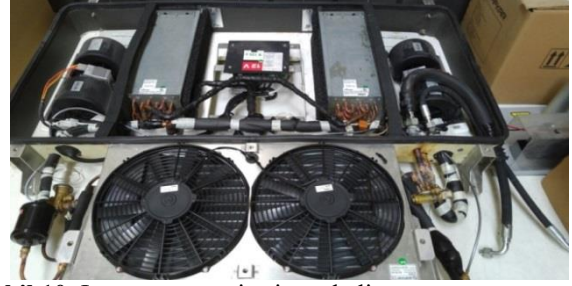
Şekil 10. Isı pompası ünitesi son hali
