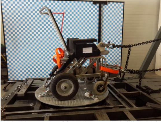
Şekil 10. Döner Tabla Referans Tekerlekli Sandalye (ISO 10542 ) Çekme Testi
