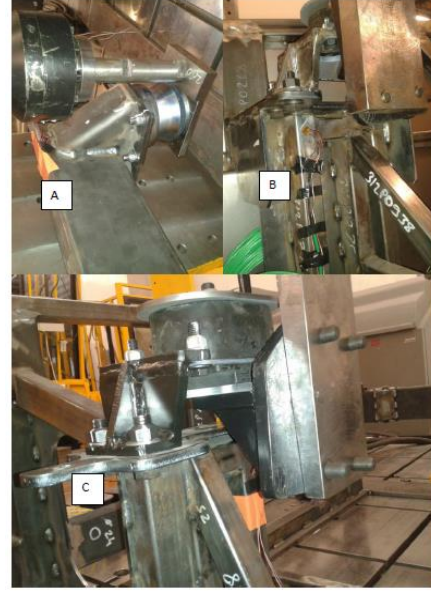
Şekil 4. Strainuagelerin Yerleştirildiği Bölgeler
