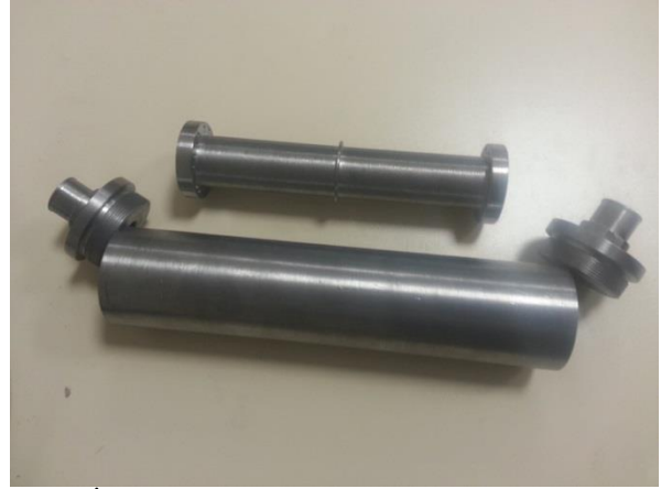
Şekil 2. İndüksiyon ısıtma kapsülü üretim aşaması
