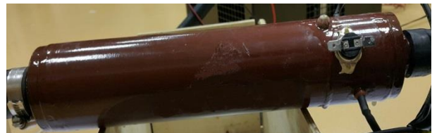
Şekil 4. İndüksiyon ısıtma kapsülü prototipi
