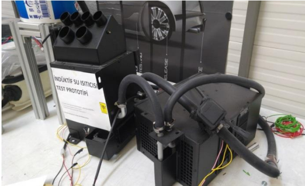
Şekil 6. İndüksiyon ısıtıcı masaüstü prototip
