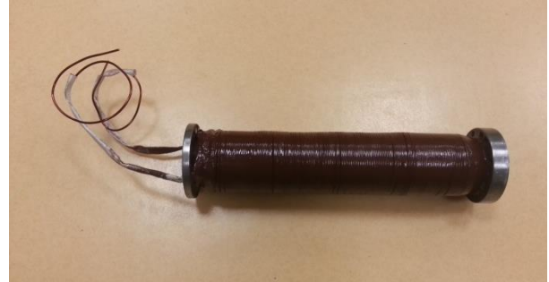
Şekil 3. İndüksiyon ısıtma kapsülü bobinajı
