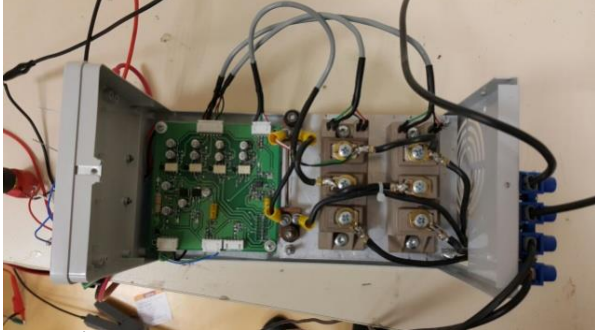
Şekil 5. İndüksiyon ısıtma güç ve kontrol sistemi
