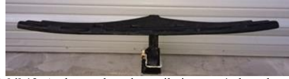
Şekil 13. Atölye şartlarında üretilmiş prototip hava kanalı
