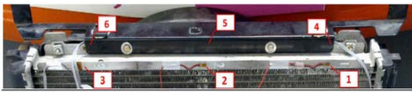
Şekil 4. Radyatör üzerinde strain ölçüm noktaları
