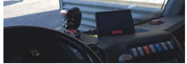
Şekil 4. Araç İçi Kamera ve Mikrofon Yerleşimi
