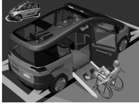
Şekil 5 Yandan biniş ve iniş elverişli rampa.
