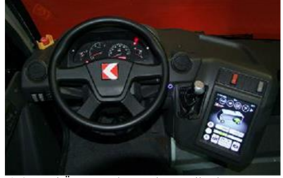
Şekil 9. Yeni Ön Konsol ve Dokunmatik Ekran Tasarımı
