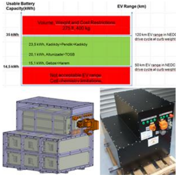
Şekil 4. Batarya Boyutlandırılması ve Batarya Paketi Tasarımı
